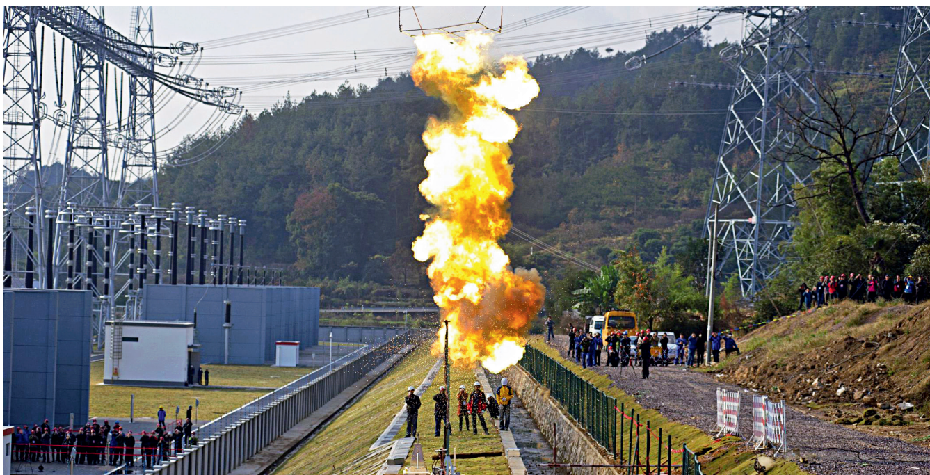
▲ 依托各级实验室，公司科研能力不断提升。图为中国电科院科研人员在浙福交流特高压工程浙南变电站现场，进行 1000 千伏特高压交流人工短路试验。
