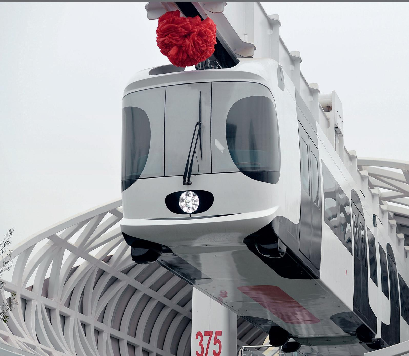
△ 11月21日，世界首条新能源空铁试验线在四川成都成功投入运行。新能源空铁是指以锂电池动力包为动力源的空中悬挂式轨道列车系统。这条全长1.4公里的新能源空铁试验线，呈U字型环绕位于成都双流空港经济技术开发区的中唐空铁产业基地，以近60公里/小时的速度平稳行驶。
