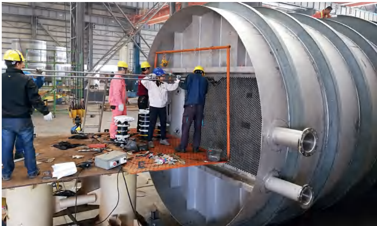
<< 印尼爪哇7号海水淡化项目蒸发器制造厂，廖海燕跟着工人一起穿蒸发器的受热面管道。
